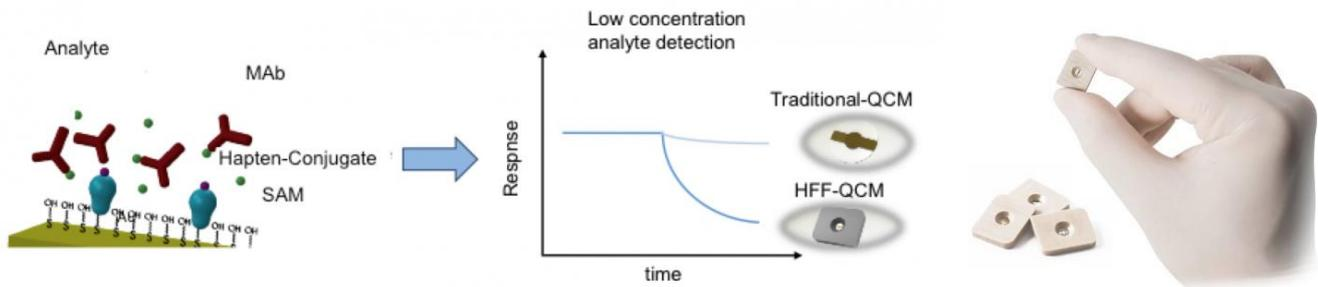
**AWS-HFF sensor 高频 QCM 传感器芯片**和常规 **QCM-AWS 芯片**相比品质因子更高，芯片更薄。在高频下操作，可提高 2 个数量级的测量灵敏度和分辨率。同时芯片面积更小，可节省样品的使用量。专有的支撑框架设计可提高芯片的稳定性和操作的方便性。
