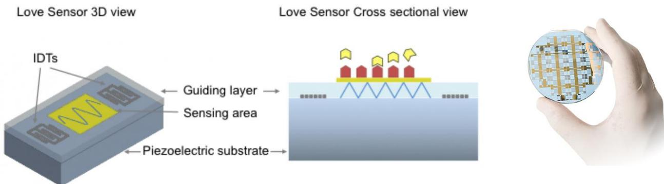
**LOVE-SAW sensors 叉指传感器芯片**由石英压电基片和叉指换能器组成，叉指换能器分别位于基片表面两端，作为信号输入和信号输出。施加在输入换能器上的交流电会产生声波，声波沿传感器表面从输入端口传播到输出端口。声波的传播局限于基片表面顶部几微米厚的引导层。当吸附在表面薄膜的质量、构象等特性变化时，声波的特性也随之改变。通过对声波变化的精确检测，实现了对吸附膜特性的精确检测。
